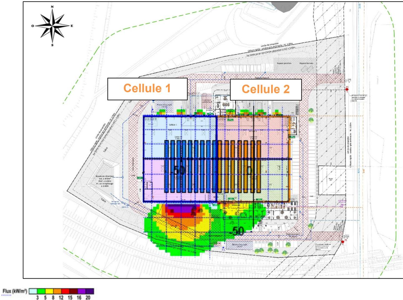
On constate que les allées rapprochées permettent d'augmenter la distance entre la paroi Ouest de la cellule 1 et les racks.
