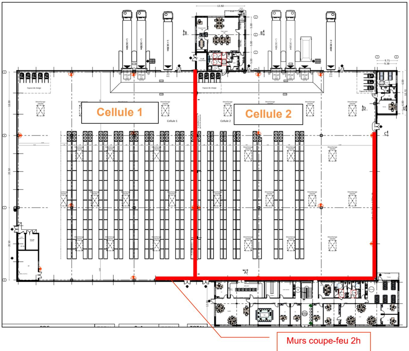
Le plan ci-dessus permet de constater que le stockage en racks avec allées de 1,85m permet d'obtenir des flux thermiques de moindre ampleur vis-à-vis d'un stockage avec des allées de 2 m en partant sur le même nombre de racks.
